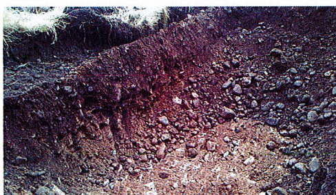
Provgropen på ängen. Markförhållandena är goda och utgörs av jord som övergår mer i grus och sten med ökat djup. Inget vatten fyllde provgropen efter att grävarbetet avslutats.
